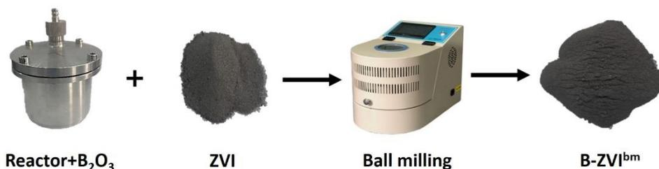
图 2-1 球磨法制备 B-ZVI<sup>bm</sup>
