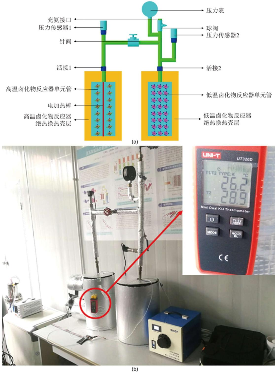
图 3-2 热化学储能型电动汽车热泵的实验测试单元 (a)理论图 (b)实际图
