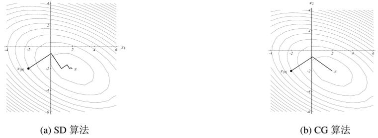
图 2-8 SD 算法和 CG 算法搜索方向示意图
