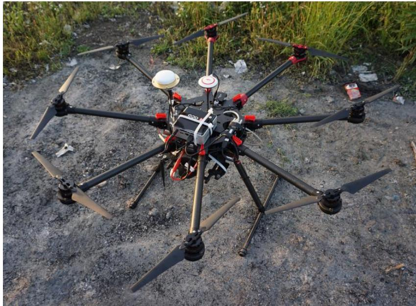
图 5-4 基础版无人机测试平台整机图示
