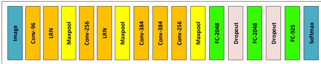
图 3-2 基于 Alexnet 的改进网络结构
