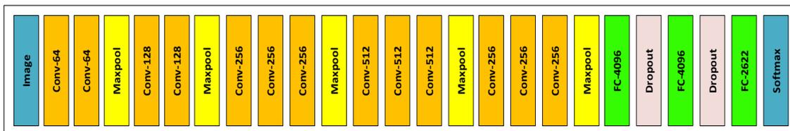
图 3-3 VGG Face 的网络结构
