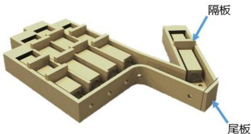
图 4-17 操作手上层铸造模具
