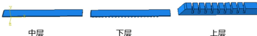
图 3-1 驱动器三层模型
