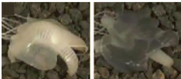
图 1-5 变色软体机器人<sup>[16]</sup>
