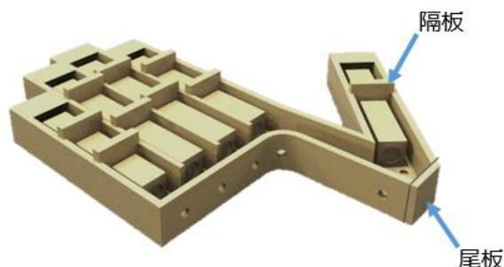
图 4-3 “拔除硅胶式” 模具
