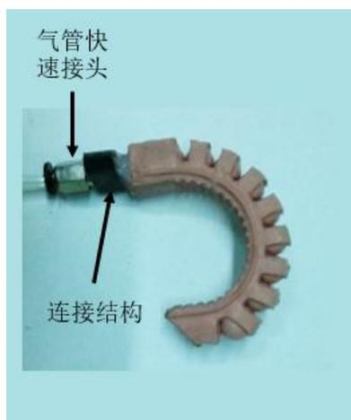
图 4-9 单个驱动器受压膨胀状态图
