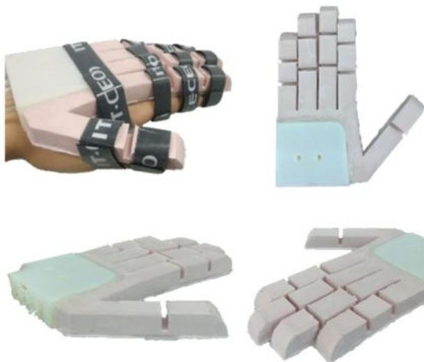
图 4-20 操作手实物图、康复训练示意图
