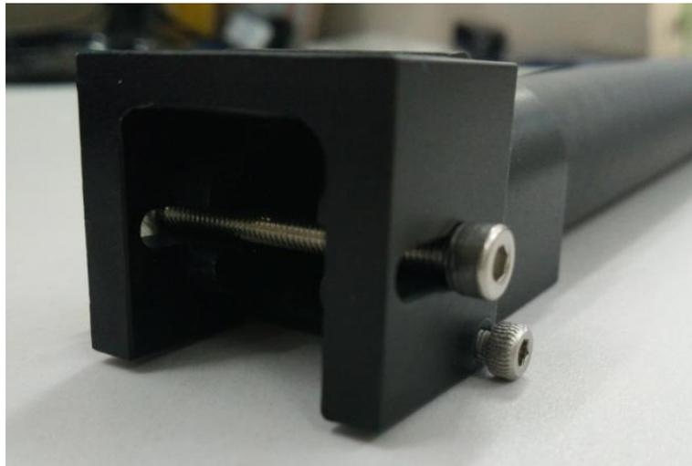
图 5-19 机翼连接处
