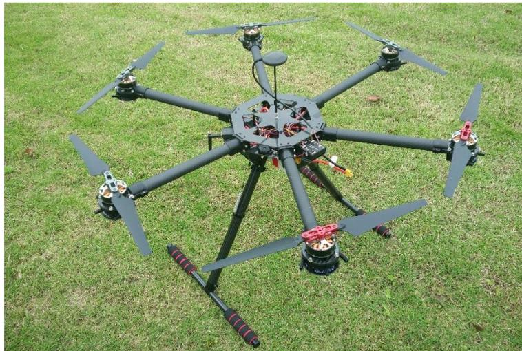
图 5-7 搭载动力系统与控制系统的六旋翼
