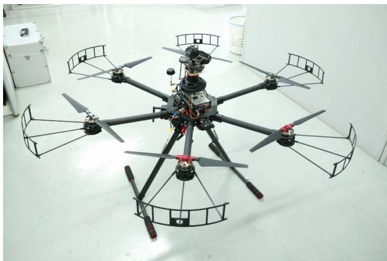
图 5-8 六旋翼最终实物图
