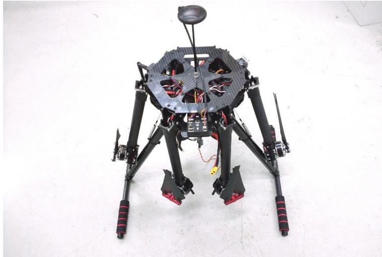
图 5-6 折叠状态的六旋翼
