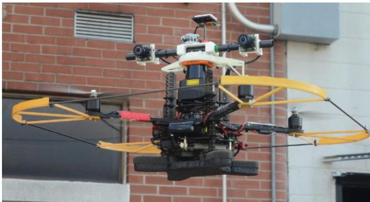
图 1-1 多传感器融合的自主飞行器
