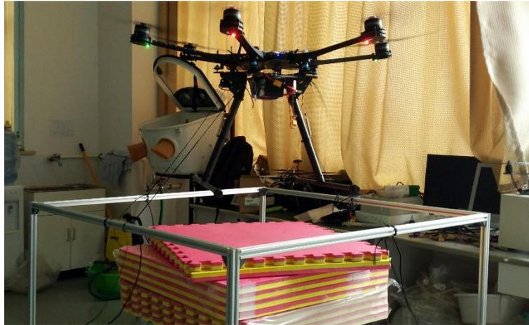
图 3-10 调节六旋翼的姿态参数
