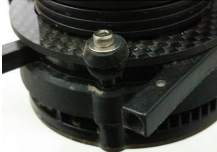
图 5-18 电机座减震装置
