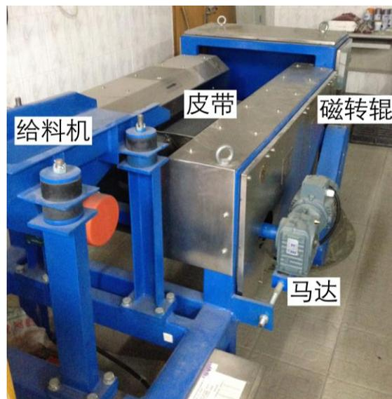
图 2-7 ESC-60 型涡电流有色金属分选机
