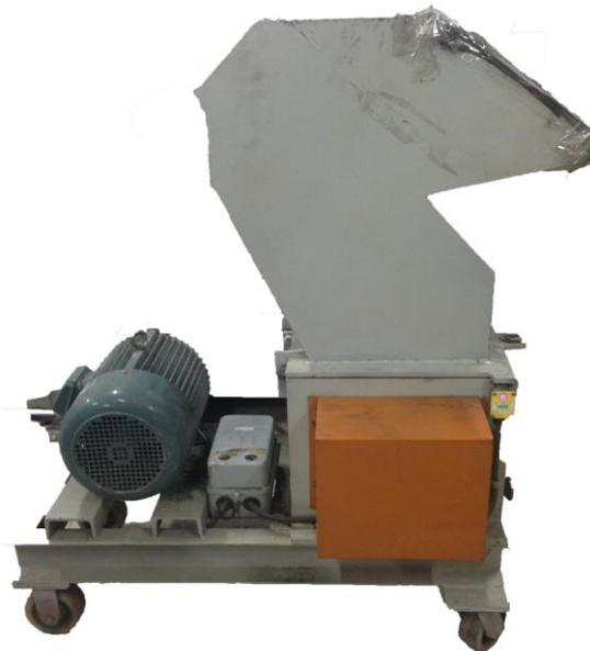
图 2-3 Y132S2-2 型破碎机
