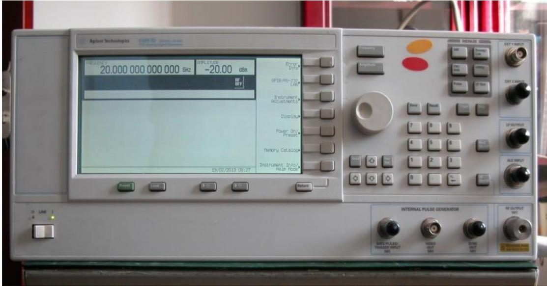
图 3-5 微波信号源实物图
