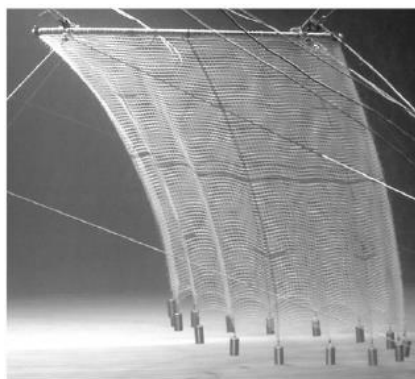
图 3-7 网箱结构发生大变形现象 [28]
