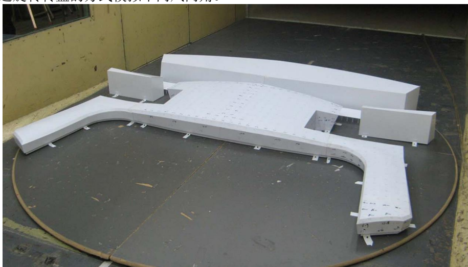
图 2-15 航站楼风洞试验模型
