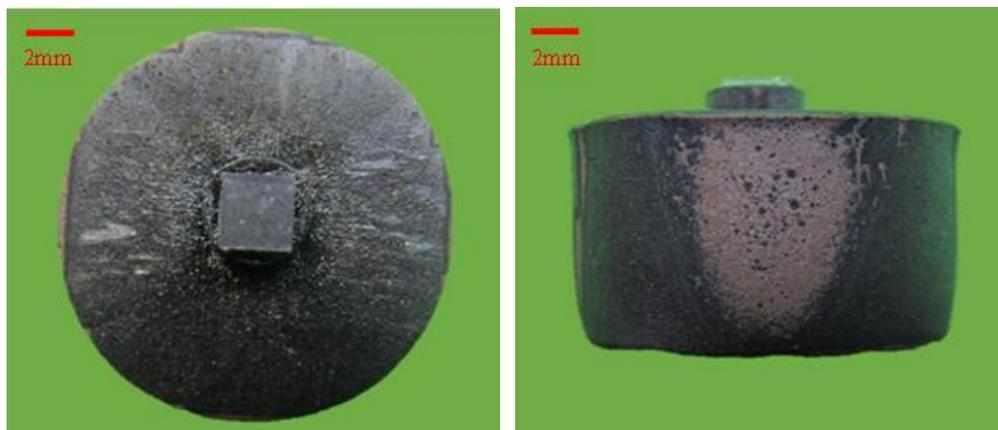
图3-7 直径为16mm的NdBCO块材俯视图和侧视图
