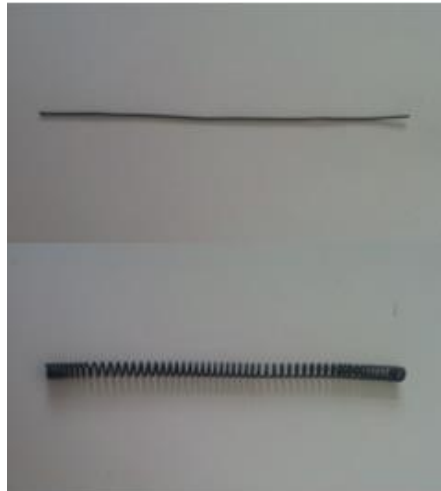
图 4.3 SMA 丝与 SMA 弹簧
